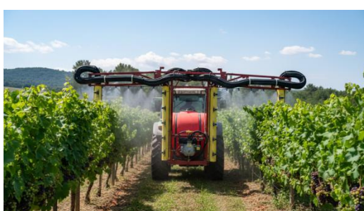
Tipo di atomizzatore – barre verticali
