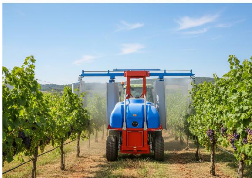
Tipo di atomizzatore – tunnel a ricircolo
