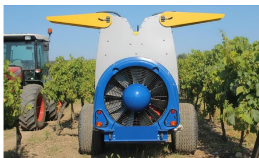
Tipo di atomizzatore – deflettori
